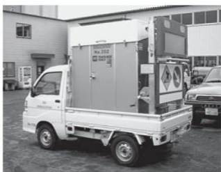
北海産業の車載トイレ。快適なトイレとLED表示板機能を合わせ持つ
