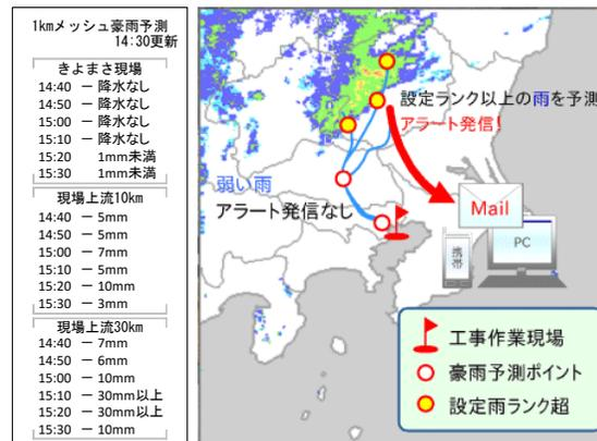
KIYOMASAは1日**288**回更新。全国どこでも1kmメッシュで豪雨と降雪(冬季)を5分毎に予測します。降水の実況を随時取り込むことで、高精度のリアルタイム豪雨・降雪予測を可能にしました。現場の緯度経度を登録しておくことで、常に現場上空の気象変化を監視でき、局地豪雨や集中豪雨対策に有効です。降水の強さを16段階で予測しており**10mm**以下については1mm単位で判別し、2mmや4mmといったコンクリートの打設可否判断に活用しやすいようになっています。また、設定ランク以上の降水が予測されると、瞬時に現場にアラートメールが通知します。河川工事の場合、上流に発達した雨雲が予測された時点で、たとえ下流にある現場に雨が降っていなくてもアラートメールが発信されます。集水地点や河川の合流地点など複数豪雨予測ポイントを持つことができます。
