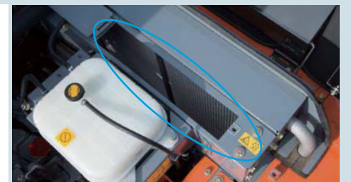
ワンタッチ開閉式のラジエータ清掃窓
