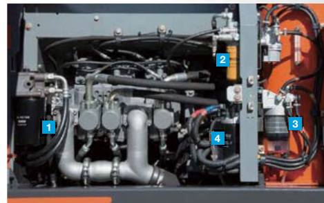
1 エンジンオイルフィルタ 2 パイロットフィルタ 3 燃料プレフィルタ 4 燃料メインフィルタ
