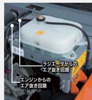
エキスパンションタンク
