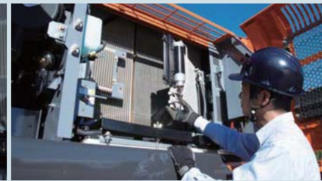
開閉式のエアコンコンデンサ
