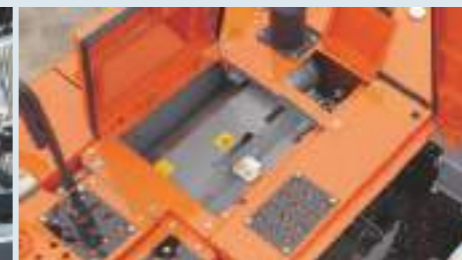
清掃性が向上したマフラフィルタ周り
