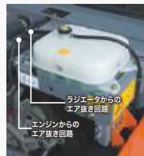
エキスパンションタンク
