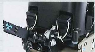
機械式駐車ブレーキ、輪止めを標準装備
