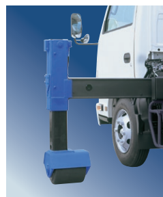
傾斜地用にローラジャッキ専用のゴム製盤木も標準装備。
