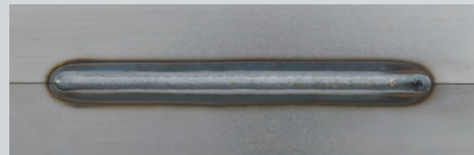
板厚:0.8mm、溶接電流:40A、 溶接電圧:16V、ワイヤ径:0.6mm、 溶接速度:45cm/min、 ガス:Ar+20%CO 2
