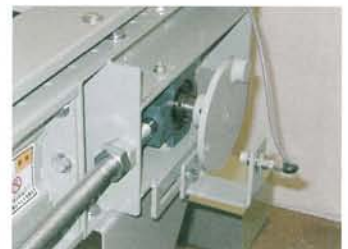
スリップ検出器（近接スイッチ） （※操作盤は含んでおりません。）
