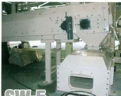
SW-5 廃蛍光管 舟底型 カレット搬送ライン
