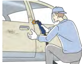
自動車板金の切断作業
