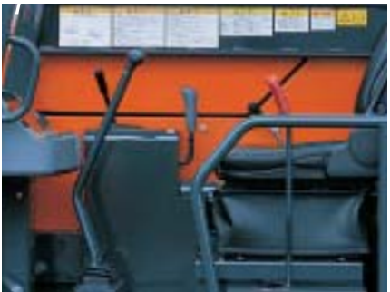
誤操作を防ぐロックレバー 走行操作系統にロックレバー機構を設け、オペレータが乗降時に、誤って機械を動かすことがないように配慮しました。
