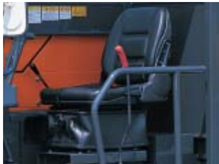
快適なリクライニングシート 体重に応じ調整が可能な、サスペンション付きリクライニングシートを採用しました。
