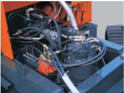
実績ある共通部品 旋回装置や足回りには、実績ある油圧シリンダと共通の部品を採用しました。
