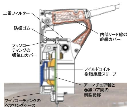
Eモータはハンドルカバー部とモータケース部を独立させ防振ゴムで接続し、手元振動を減らす構造とフィルドコイル部やアーマチュア軸にも樹脂絶縁を施した、二重防振・二重絶縁の特許取得のモータです。
