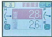
実荷重・定格荷重・負荷率表示 (写真は過負荷警告表示時)
