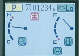
バッテリー充電異常表示
