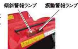
傾斜警報ランプ
