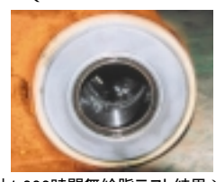
WC溶射処理:傷なし(当社1,000時間無給脂テスト結果)
