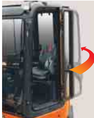
ZX30U-2は、ドア開放時に後端旋回半径からドアが25 mm出っ張ります。
